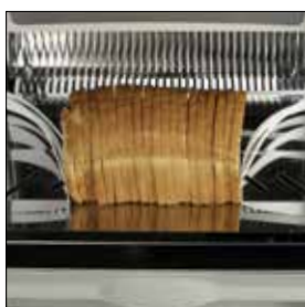
JAC FLAPS Assure le maintien du pain à la sortie de la trancheuse pour faciliter la prise en main.
