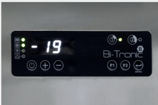
Ultra-simple d'utilisation, l'interface Bi-Tronic Control permet de gérer 2 programmes de température.
